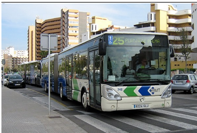
Palma de Mallorca, s'Arenal, Carrer Marbella, osiemnastometrowy Irisbus Citelis. Citelisy (w wersjach 12 m i 18 m) są najnowszymi nabytkami przedsiębiorstwa EMT Palma de Mallorca.
