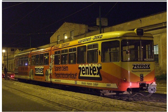
GT8 2657 (701) w kolorowej reklamie marketu meblowego Zentex. Widoczny oryginalny układ lamp z tyłu pojazdu i sprzęg Scharfenberga.
