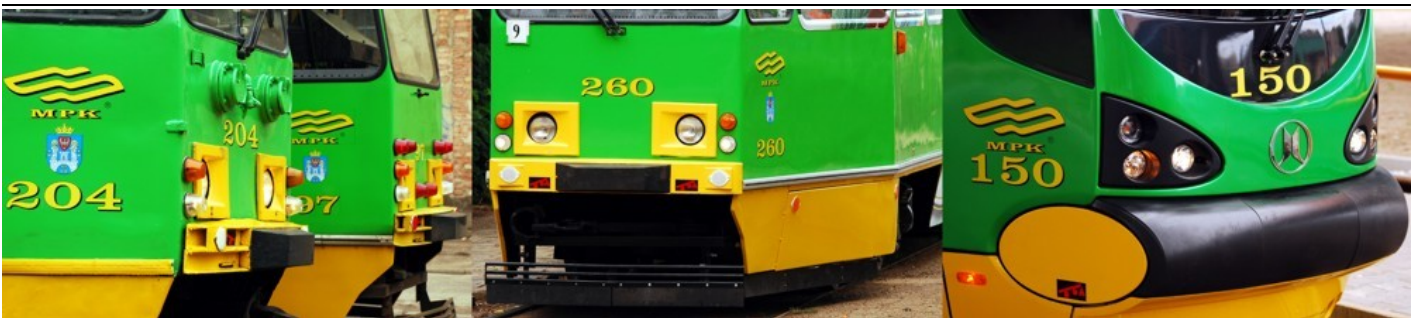
Od lewej: zderzak starego typu, tzw. taran, nowy typ zderzaków znany z wcześniejszych modernizacji, zupełnie nowy zderzak, charakterystyczny dla wagonów Moderus Alfa.
