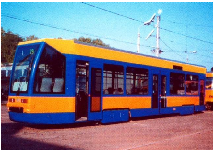
Niskopodłogowa doczepa bierna NB4 w Lipsku.
