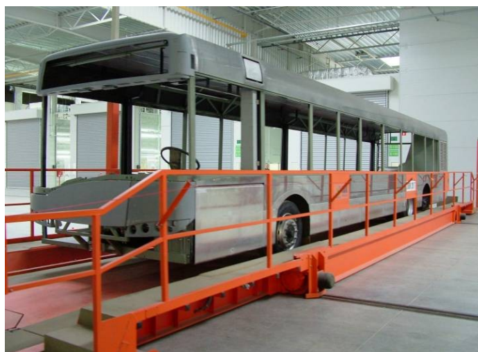
Nowy system transportu wewnętrznego. Pojazd załadowany na przesuwaną po hali rampę.
