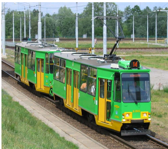
Skład #136+137 najlepiej wygląda... z góry. Cechy charakterystyczne: elektroniczna tarcza dachowa, klimatyzacja i połówkowy pantograf. Fot: Mikołaj Wydra, 28.06.2005
